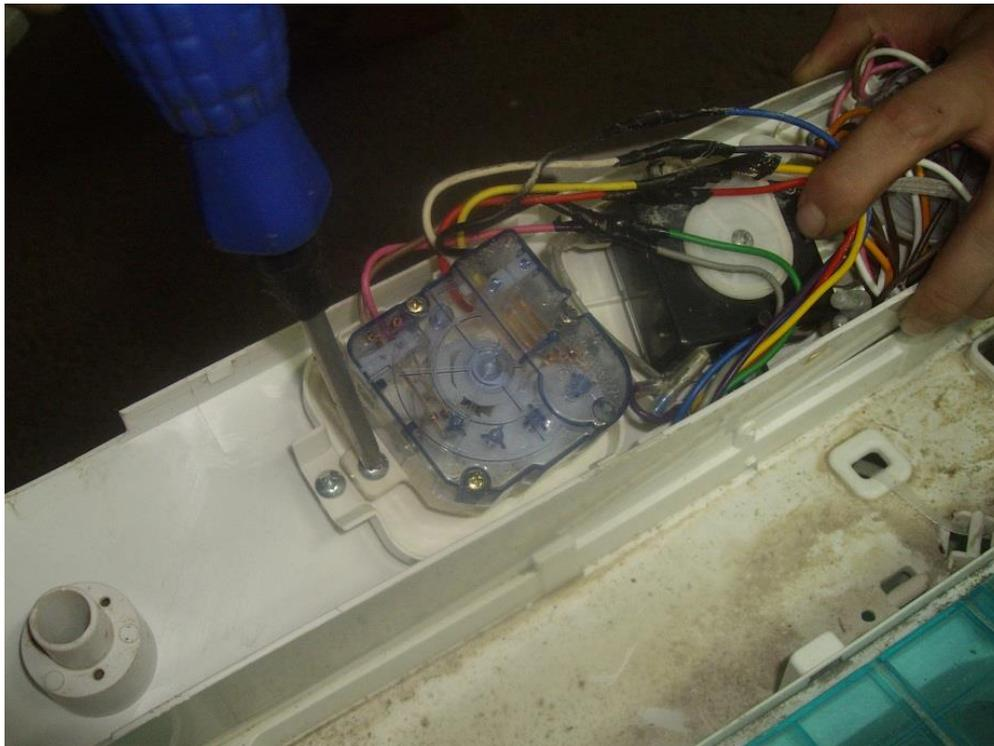
6. Отсоедините декоративную ручку таймера от самого таймера
