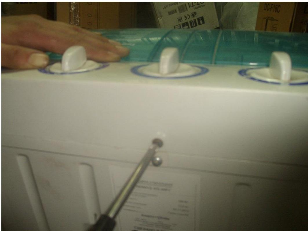
4. При помощи подручных инструментов (плоская отвертка, нож...) отсоедините панель управления от корпуса и переверните ее
