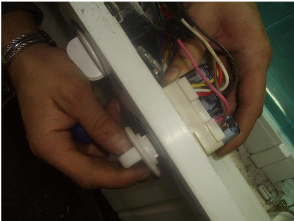
7. Отсоедините электропроводку «старого» таймера (обязательно запомните провода соединений по цвету);
