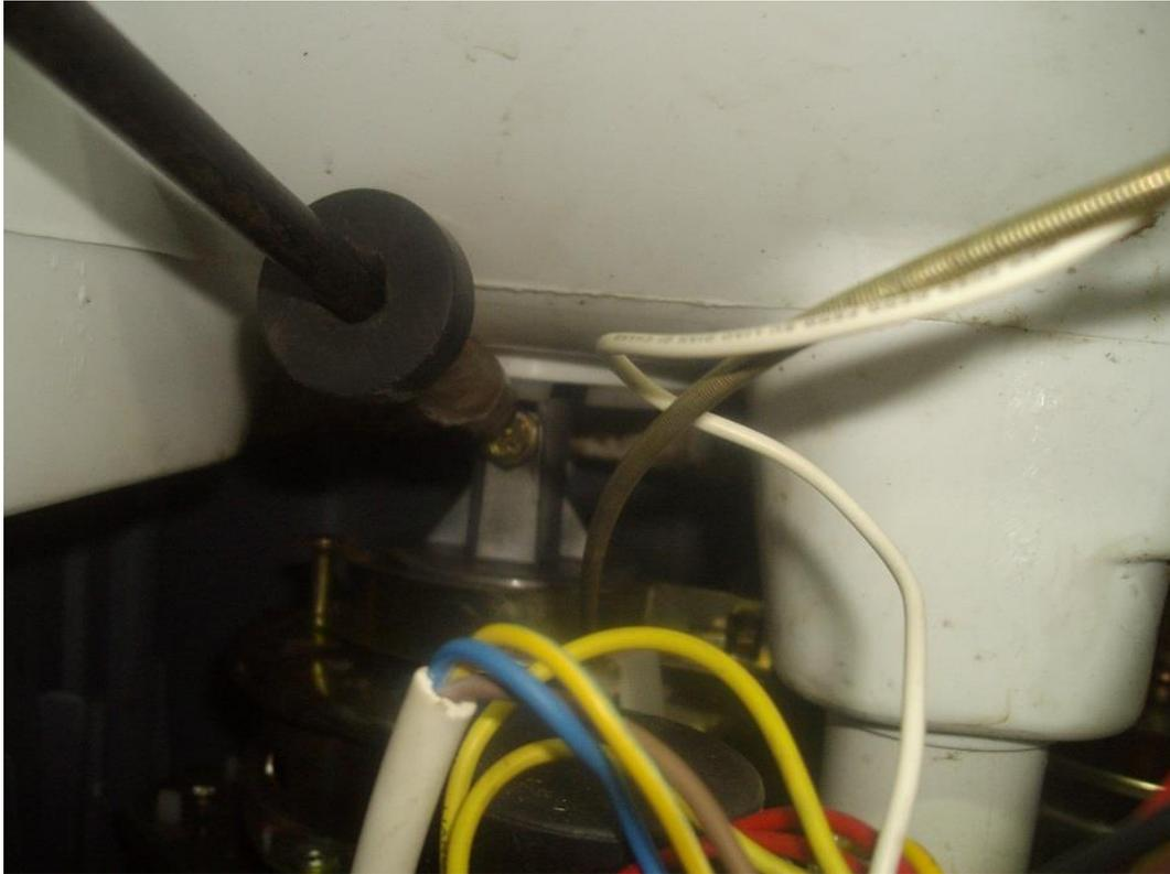
4. Снимите ремень привода активатора (неудобный процесс — необходимо вслепую нащупать ремень привода рукой и снять его);
