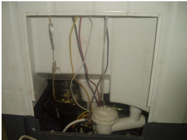
2. Снимите тросик блокировки центрифуги (пластмассовый крепеж вниз до разъединения, затем отсоедините сам тросик)
