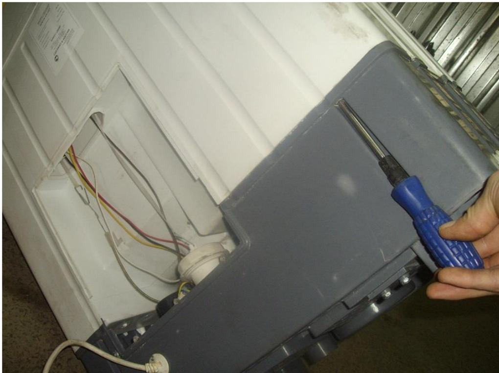
6. Аккуратно снимите корпус относительно основания, чтобы был доступ к двигателю.
